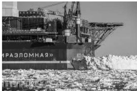
**Рисунок 1. Ледовый дефлектор платформы «Приразломная»**
