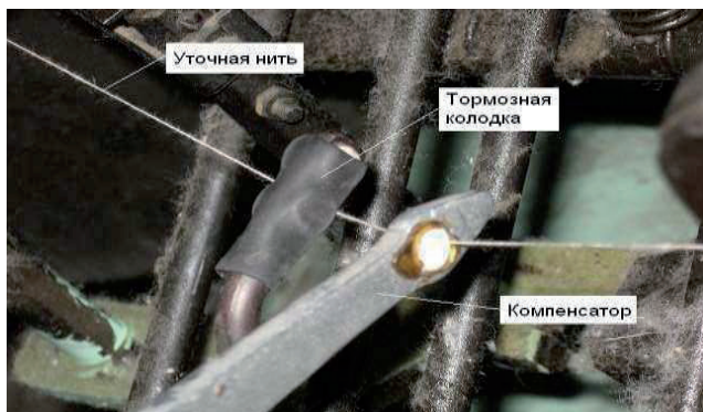
Рис.8.16. Общий вид модернизированного уточного тормоза.
