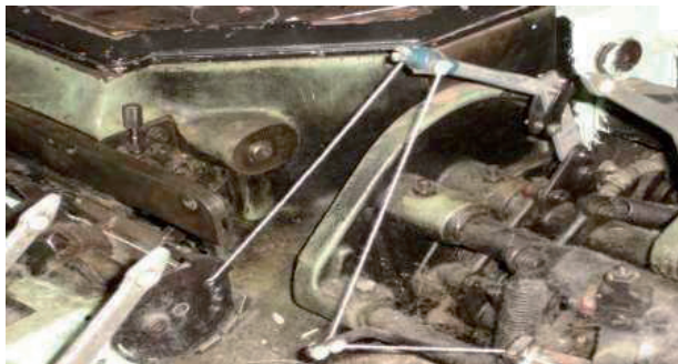
Рис.8.20.Общий вид безударного уточного тормоза.
