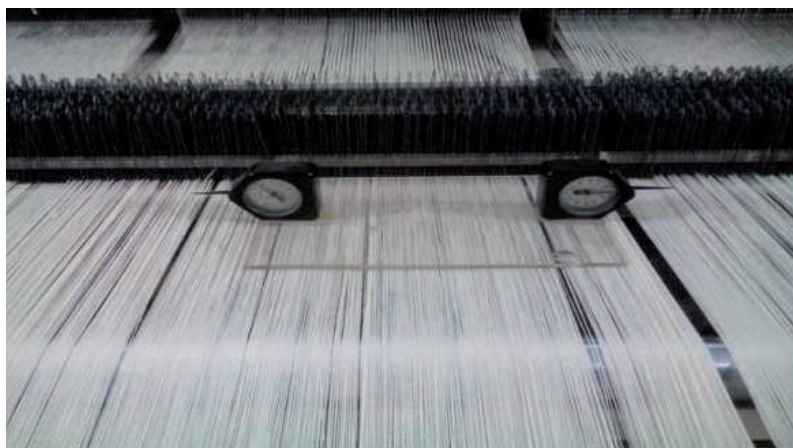
Рис.2.4.Прибор для измерения натяжения одиночных основных нитей на ткацком станке.
