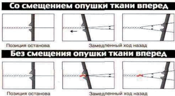
Рис.7.8.Взаимодействие берда с опушкой ткани при прибое утка.
