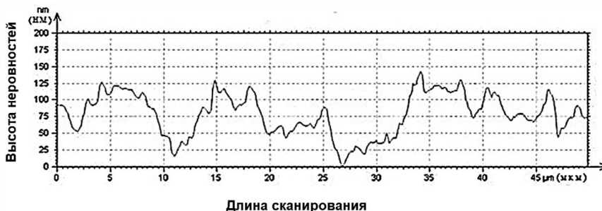
Рисунок 4. Сканированный профиль боковой поверхности зуба без обработки
