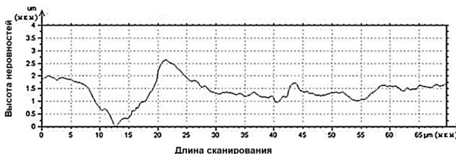
Рисунок 5. Сканированный профиль боковой поверхности зубьев лентерных пил после абразивоструйной обработки
