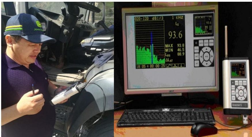
Рис. 2. Процесс измерения шума, вибрации и обработка результатов с помощью компьютера
