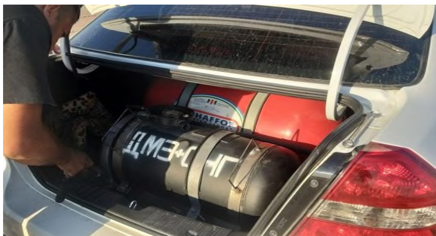
Рис. 3. Подготовленный к испытаниям автомобиль Нексия 3
