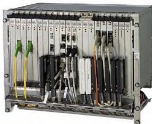
3-расм. UMUX 1500 мултиплексори ва боғловчи кабел (patching cord)
