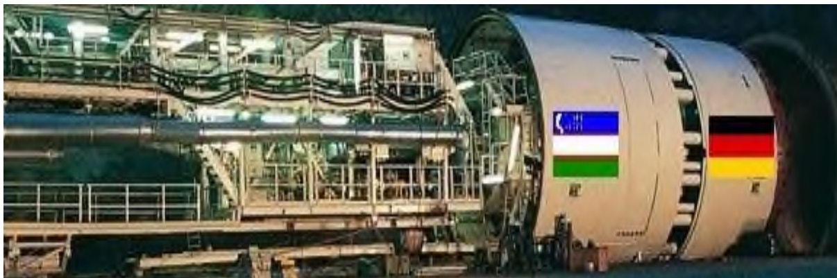
Рис.1. Тоннелепроходческий механизированный комплекс (ТПМК) с грунтовым пригрузом компании «Herrenknecht» AG.
