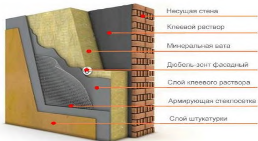
Рис. 2. Способ дополнительного утепления стен с использованием армированной штукатурки.
