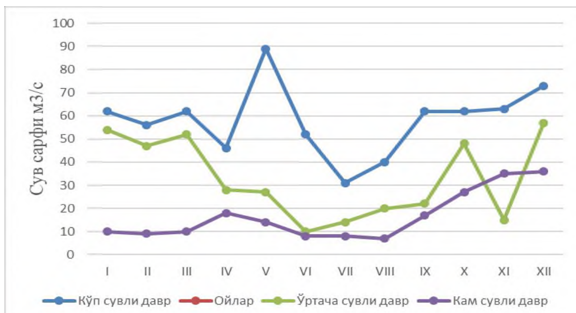
2-расм. Чортоқсойнинг кўп сувли, кам сувли ва ўртача сувли йилларидаги гидрографи
