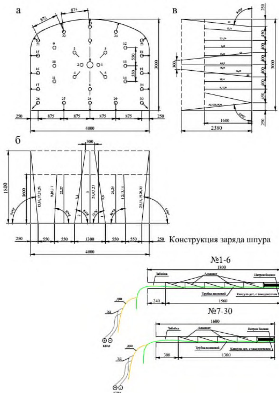
Рис. 3.4. Рекомендуемый паспорт БВР на проходку штрека 26, гор +860 м на руднике «Каульды»
