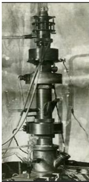
Рис. 3. Электронный микроскоп А.А. Лебедева (1934-1943)
