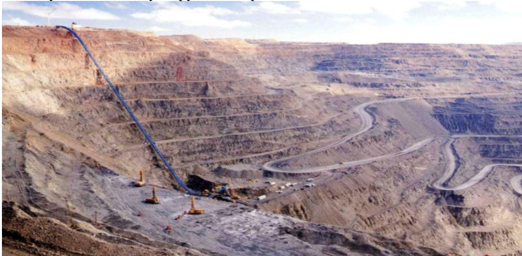
Рис. 1. Крутонаклонный конвейер карьера Мурунтау (КНК-270)
