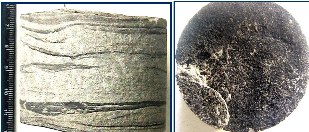
Фото 1. Песчаник серый, светло-серый, с многочисленными включениями растительного детрита, месторождение Северный Бердах, скв. 10, инт. 2340-2346 м
