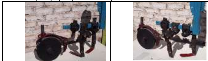
Рис.2.Экспериментальной секции сеялка-культиватора снабженным с односторонним плоскорезушим лапами и дисковым сошником
