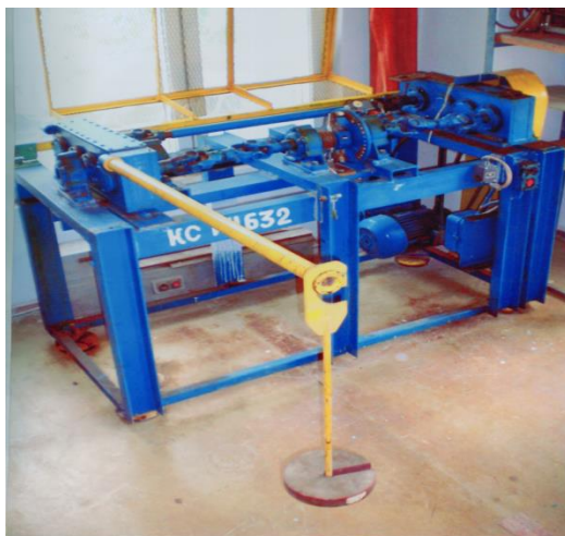
1-расм. Куч узатмалари деталларини ейилишга бардошлилигини синашнинг кучлар контури ёпиқ стэнди.
