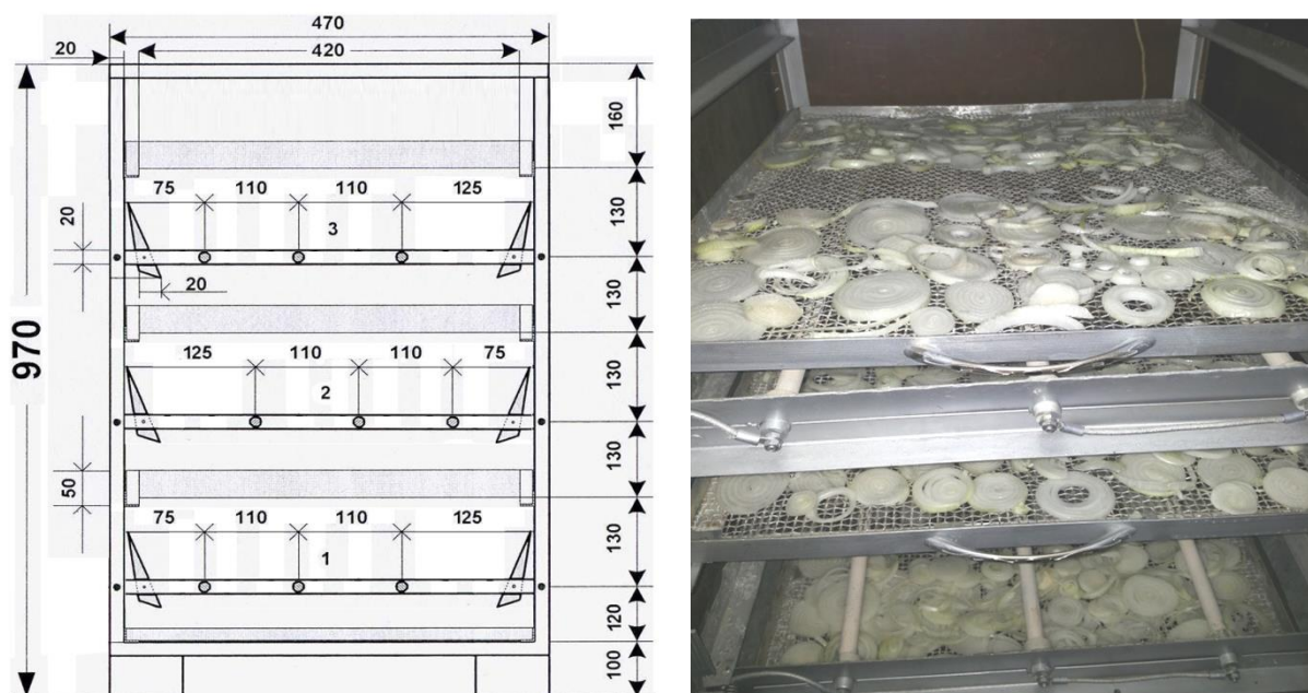
1-расм. Маҳсулотларни инфрақизил қуритиш ускунасининг схематик ва иш жараёнидаги кўриниш схемаси
