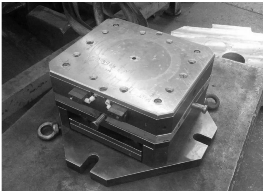
Рисунок 12. Пресс-форма для литья детали «Обтекатель»
