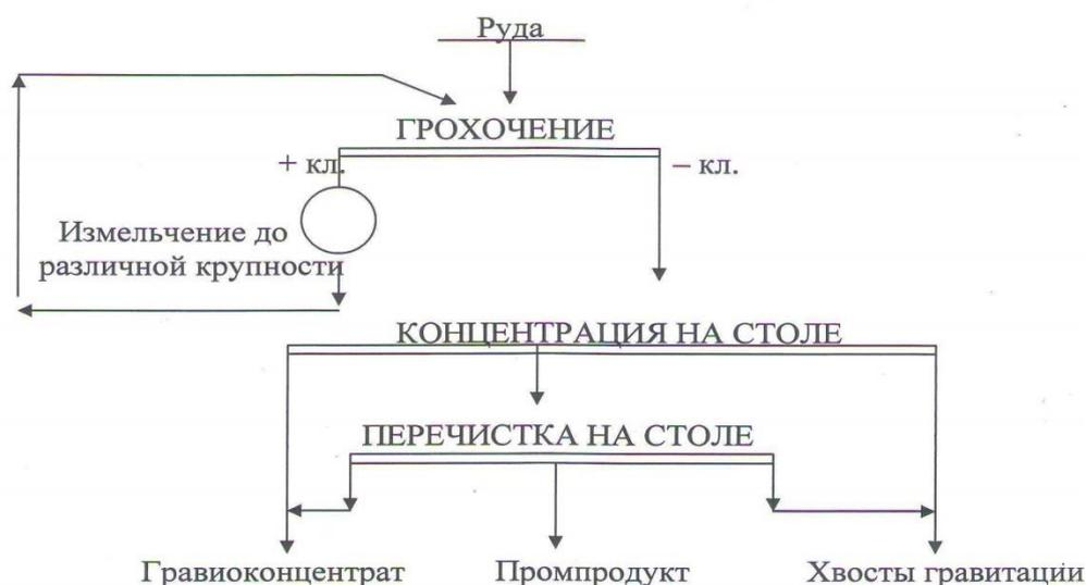
**Рисунок 1 - Схема гравитационного обогащения руды (отходы ГМЗ -3,4)**
