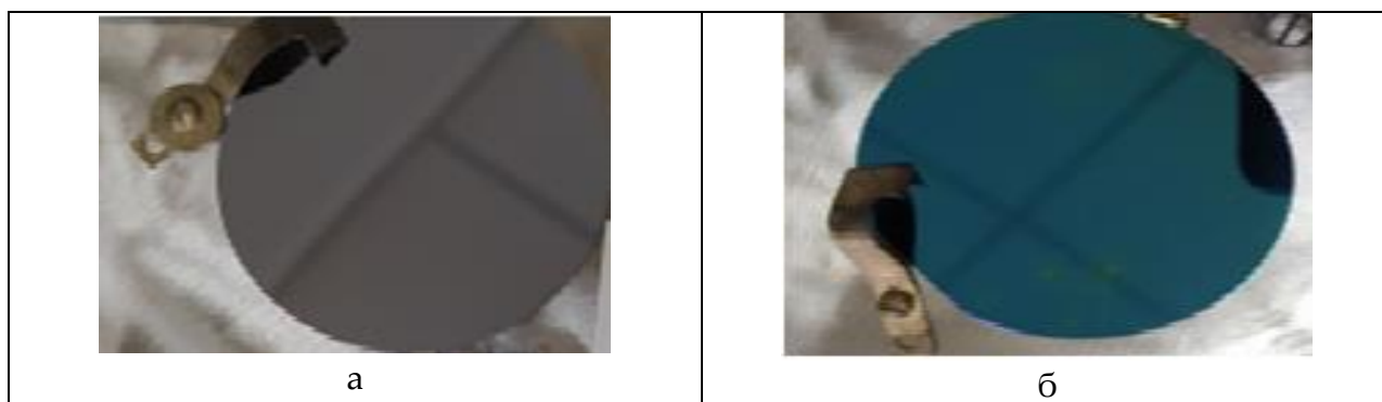
Рис.5- Кремниевые пластины до (а) и после (б) осаждения покрытия
