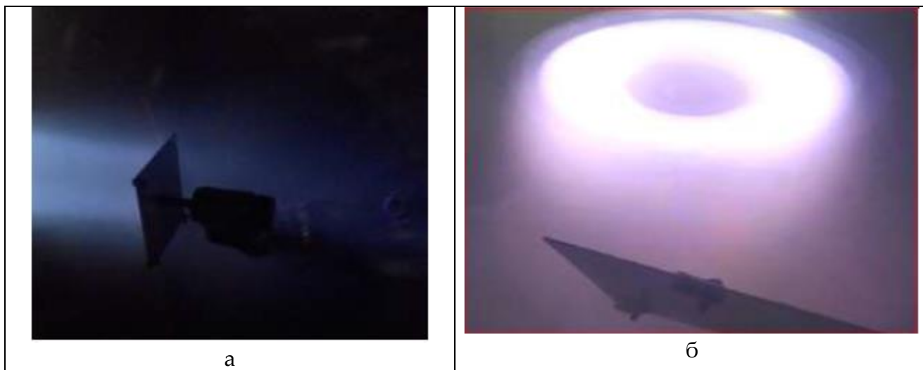
Рис.3-Процесс плазменной обработки (а) и магнетронного распыления (б)
