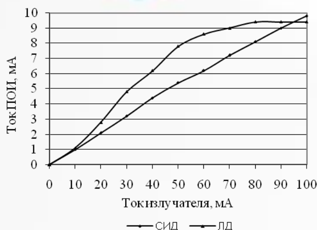
Рис. 2. Характеристика оптронной пары ИЗЛ-ФД
