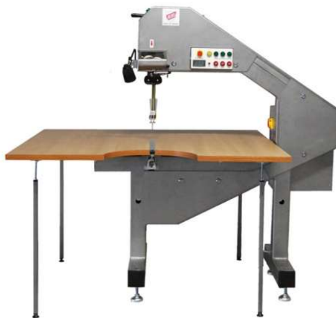
1.13- rasm. Yuqori aniqlikda bichuvchi REXEL R750 markali qozg`almas lentali bichish mashina
