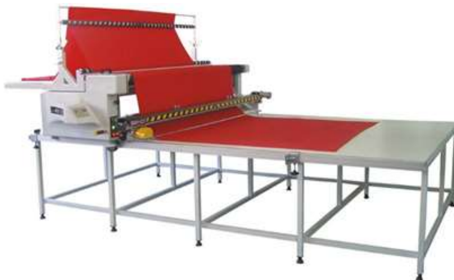
1.9-rasm. Og'irligi 50-120kg bo'lgan rulon materiallarni qo'lda to'shash stoli
