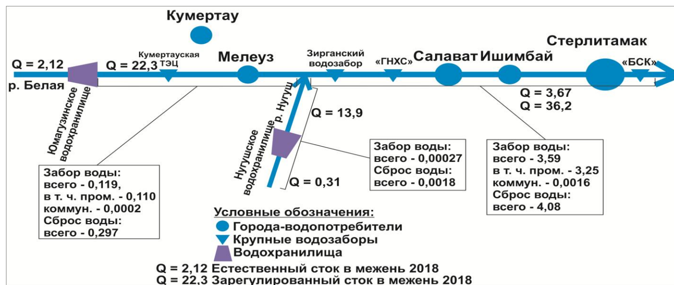
Рис. 1. Схема суммарного забора и сброса воды в среднем течении р. Белая (м 3 /сек) [1,5]
