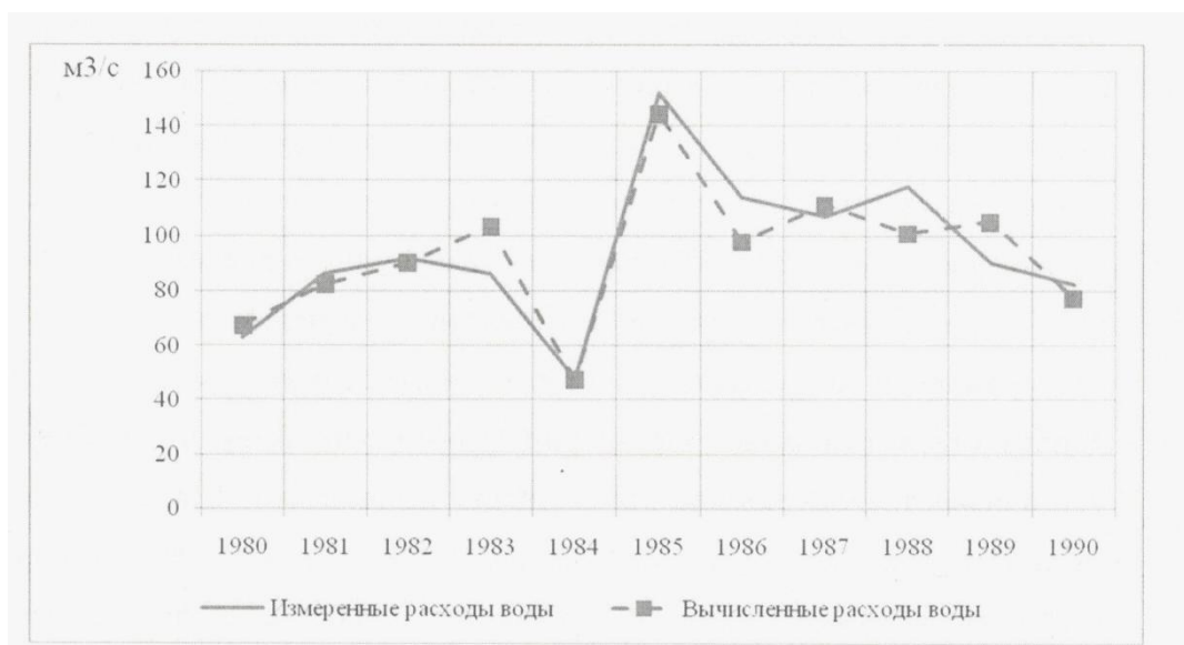
Рис. 2. Совмещенный график измеренных и вычисленных максимальных (прогнозных) расходов воды р. Сюнь – Миньярово (м³/с)
