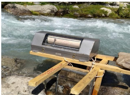
1-расм. Барқроқсойга ўрнатилган ГР-38 ўзи ёзар сув ўлчаш қурилмаси ва Барқроқ музлиги ҳудудига ўрнатилган метеорологик станция
