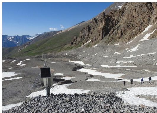
1-расм. Барқроқсойга ўрнатилган ГР-38 ўзи ёзар сув ўлчаш қурилмаси ва Барқроқ музлиги ҳудудига ўрнатилган метеорологик станция
